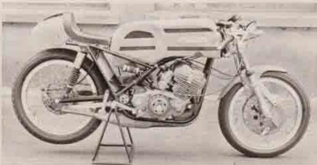
La moto completamente ridisegnata per la stagione 1972. Baricentro abbassato grazie al telaio di disegno più razionale. Motore potenziato a 52 CV a 11.400 giri mediante quattro travasi per cilindro anziché due, alettatura più sviluppata, aumento del rapporto di compressione (da 12 a 13), ecc. Senso di rotazione invertito per far «appoggiare» il pistone dal lato aspirazione e ottenere così una maggior tenuta per i gas: conseguente adozione del cambio in cascata per «raddrizzare» il senso di rotazione del pignone uscita cambio. Camere di manovella e scatola del cambio indipendenti. Peso 110 kg.
