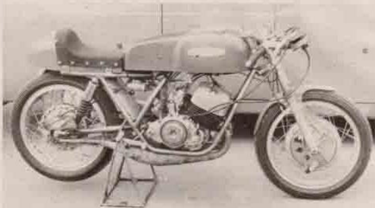
La prima HD 250 del 1971. I cilindri erano quelli dell'«Ala d'Oro» 125 e pertanto in ghisa, con alesaggio e corsa di 56 \times 50 \times 2 = 246,3 cc. Il carter era in un sol pezzo e comprendeva lo scompartimento per il cambio. Accensione elettronica, trasmissione primaria ad ingranaggi, carburatori da 30 mm, cambio a sei marce in presa diretta. Potenza 46 CV a 10.500 giri, peso 125 kg.
