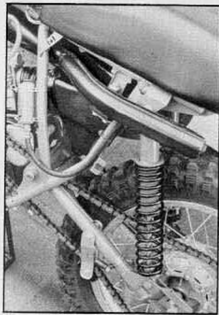
Il prototipo dell'HD 250 MX, esposto al motosalone di Milano 1975, era caratterizzato dalla sospensione posteriore a forcella Kayaba. Successivamente questa soluzione è stata scartata per ridurre il peso delle masse non sospese ed anche perché nel frattempo si erano resi disponibili nuovi ammortizzatori Kayaba in grado di fornire un ottimo servizio. L'escursione molleggiante della ruota è di 220 mm. Le fiancate di plastica nascondono la cassetta di aspirazione al cui filtro si accede togliendo un coperchio sulla destra.
