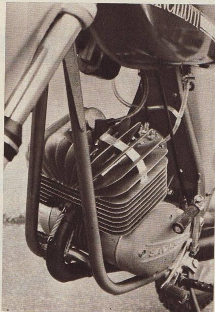
*Il motore Sachs ha l'accensione elettronica, la trasmissione primaria ad ingranaggi e il cilindro in lega leggera con la canna cromata. Nella versione Codice, esso viene alimentato da un carburatore Dellorto SHA con diffusore da 12 mm, mentre per le altre versioni vengono impiegati carburatori da 22 mm. Notare i due rubinetti, le due mollette per l'attacco del tubo di scarico, la posizione della bobina AT.*
