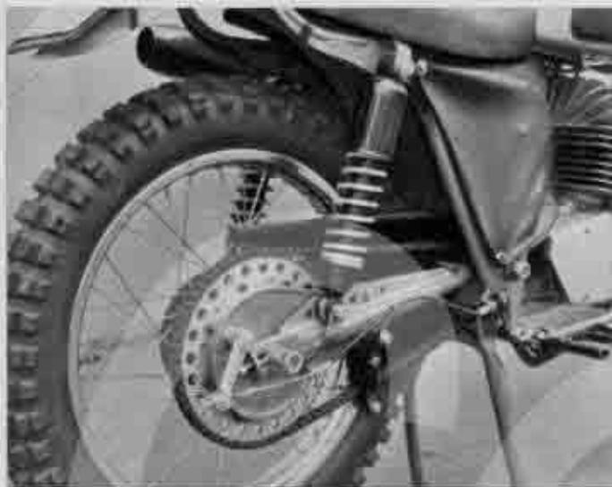
*Il mozzo posteriore con il freno a tamburo laterale che porta la corona consente una facile rimozione della ruota in caso di foratura. Si notano anche il largo carter copricatena e la cruna inferiore che guida la catena stessa. In questo caso per la copertura è stata data la preferenza alla Metzeler.*
