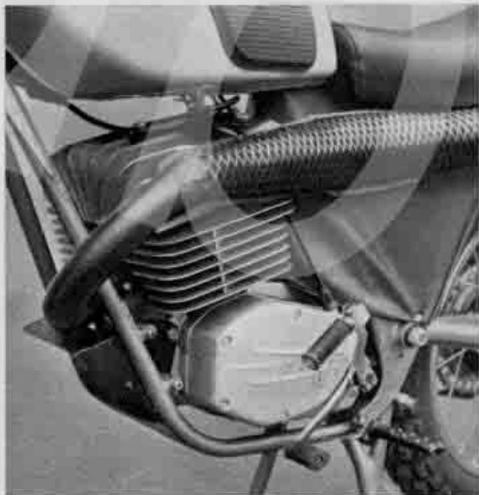
*Le due belle inquadrature del motore Sachs 125 mostrano le dimensioni notevoli della testa « panoramica » e del cilindro in lega leggera. Un piccolo riparo anteriore protegge il carter ed il cilindro dalle proiezioni di fango.*
