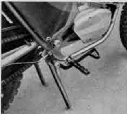
*I comandi a pedale sono tutti ben disposti e facilmente azionabili. Qui vediamo la leva che comanda il freno posteriore tramite un cavo flessibile dotato di registro.*
