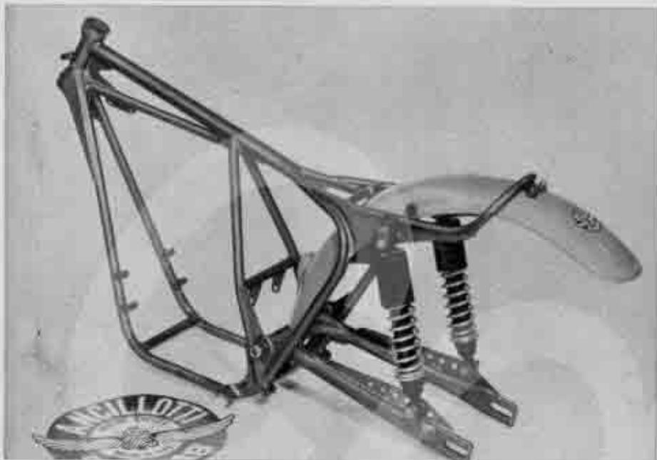
*In evidenza il disegno del telaio, nitido, solido, compatto e ben rinforzato nei punti più delicati; il forcellone oscillante posteriore lavora su silentbloc che conferiscono elasticità e durata all'articolazione. Data la sua notevole altezza da terra, inferiormente la culla presenta soltanto un traversino di riparo. Notare anche l'allettatura del carter.*
