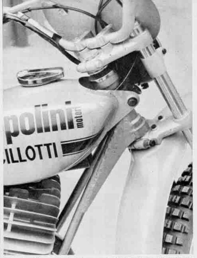
Il cannotto dello sterzo è articolato su una cappia di cuscinetti a rulli conici (brevetto Ancillotti), il che garantisce maggiore durata del complesso e riduce la munutenzione. Qui si nota l'attacco del parajango sulla piastra inferiore della forcella ed il piccolo serbatoio « crossistico »
