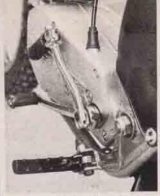
I conundi a pedale sul lato sinistro, con la leva del cambio e quella dell'avviamento con il tulcro in comune. Sempre agevole la presa della leva del cambio e ben aderente al carter la leva dell'avviamento.
