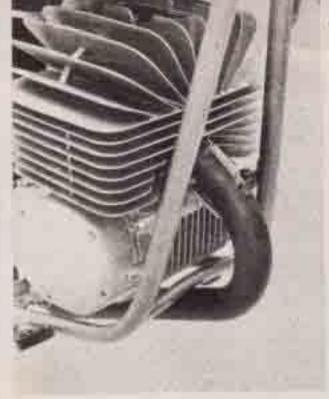
Il noto motore Sachs GS 125 vanta una eccezionale superficie di raffreddamento: radiale per la testata e squadrata per il cilindra. Notare la bella culla del teluio e l'attacco a molla dello scarico.
