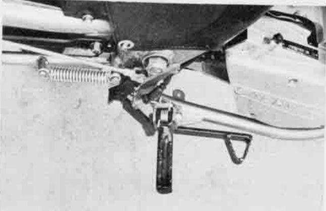
Apprezzabile il pedale del freno posteriore soprattutto per la vasta superficie di appoggio. Le pedane appoggiapiedi sono ribaltabili e tutte le superfici sono zigrinate per un migliore ancoraggio.
