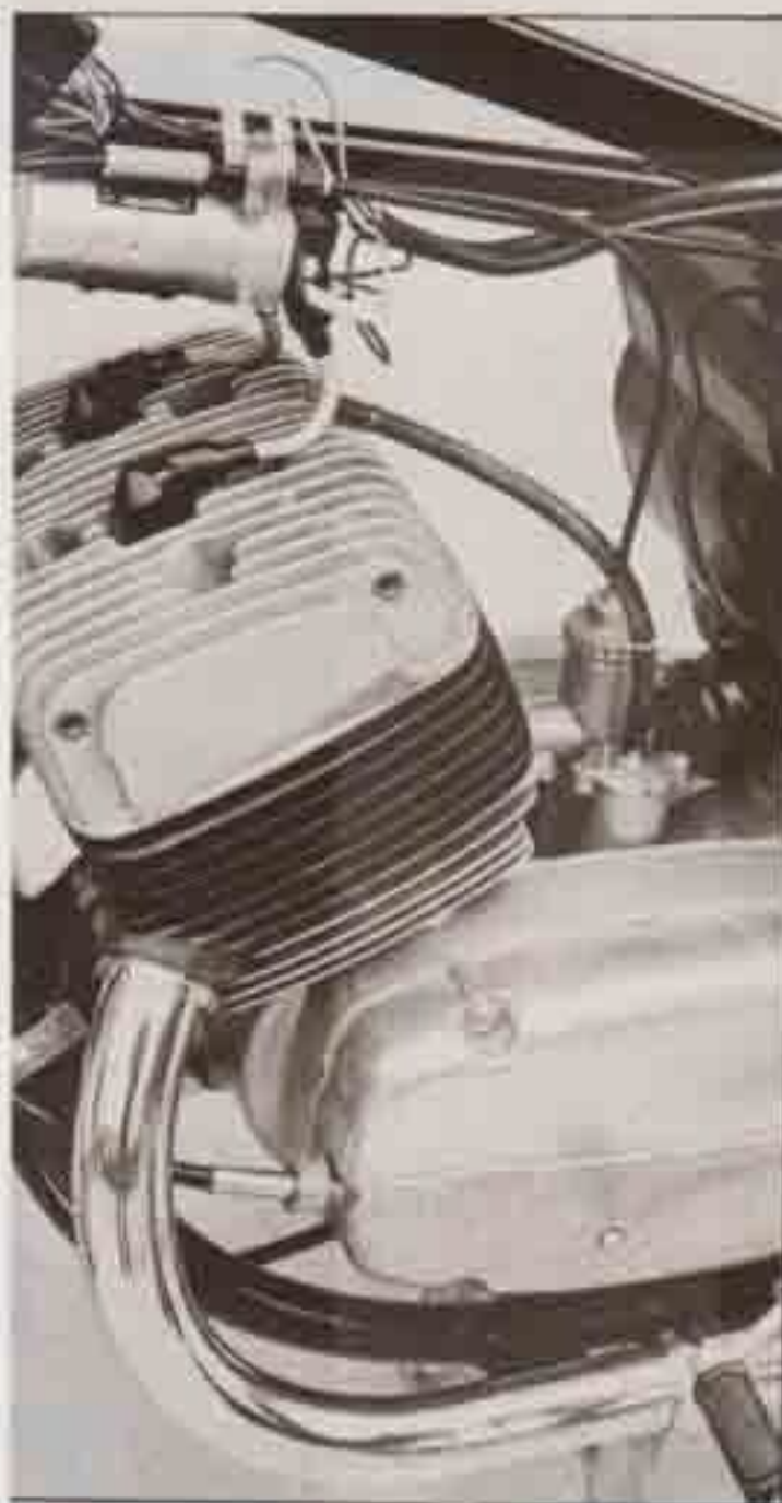
Nei coperti del carter troviamo a sinistra la catena dup'lex per la trasmissione primaria ed il pacco della frizione entrambi in bagno d'olio. A destra c'è invece la dinamo col ruttore d'accensione, il cavo e il leveraggio della frizione. In alto ma armonico il disegno del blocco motore. In evidenza anteriormente sulla sinistra la presa di moto del contagiri.
