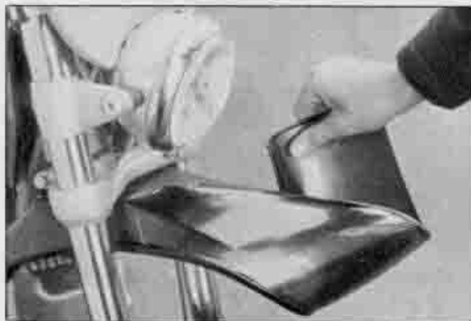
I parafanghi in plastica flessibile e il fanale montato elasticamente.
