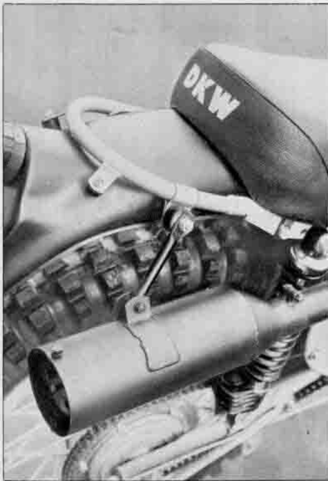
Serbatoio, parafanghi e complesso di scarico sono montati elasticamente. Il «coperchio» del silenziatore è facilmente smontabile per disinquinare l'interno.
