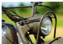
Schön ist nicht wichtig: Der Schutzbügel des Scheinwerfers folgt eher praktischen als ästhetischen Richtlinien
