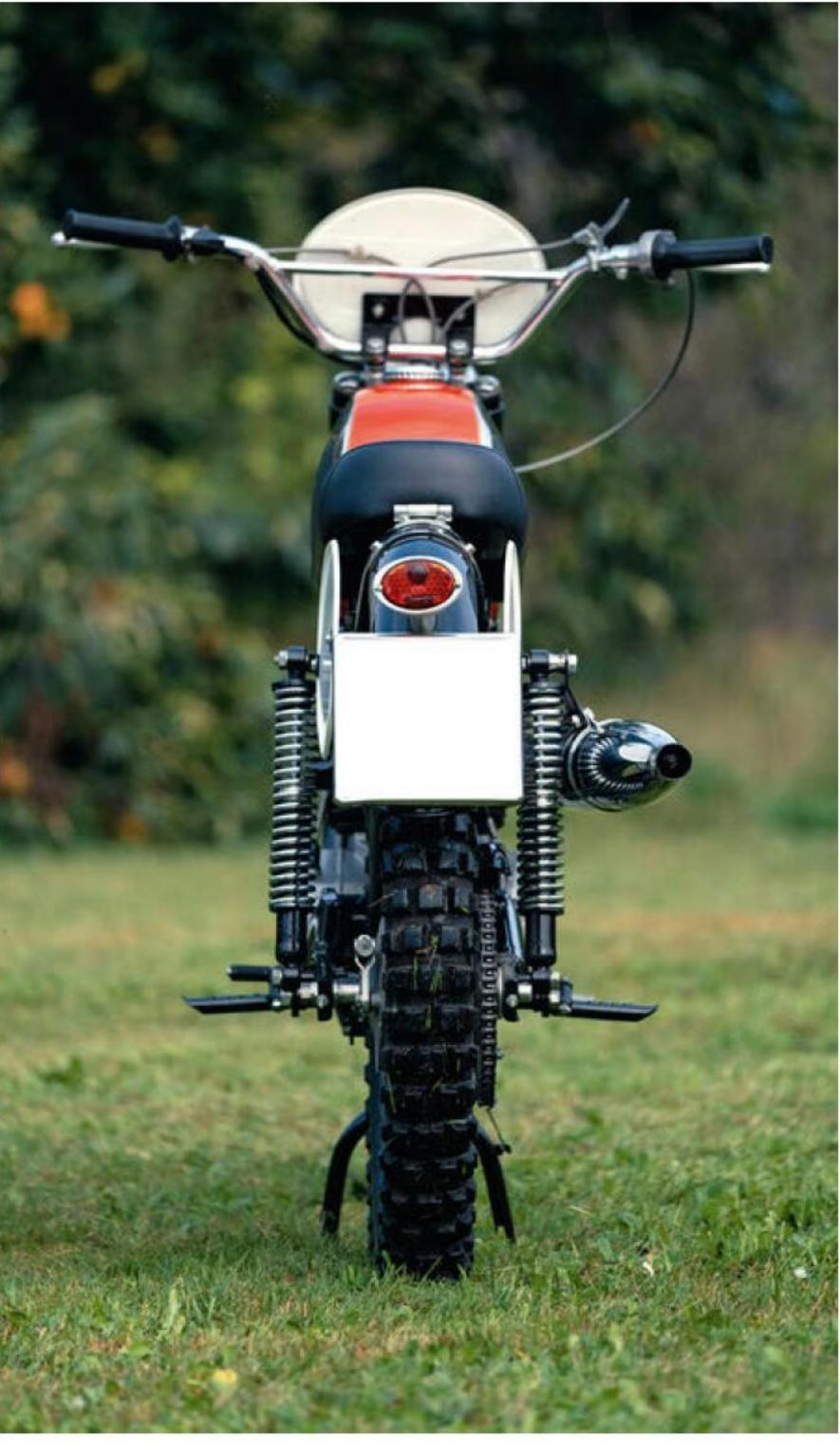
In alto, il grosso tubo di scarico protetto da una piccola griglia anch'essa cromata occupa il lato destro. Il serbatoio di foggia rettangolare, dalla forma non proprio ergonomica, è cromato sulle guance e dotato di ginocchiere in gomma. Qui sopra, le viste fronte e retro evidenziano il complesso dell'espansione di scarico particolarmente esposto sulla destra.
