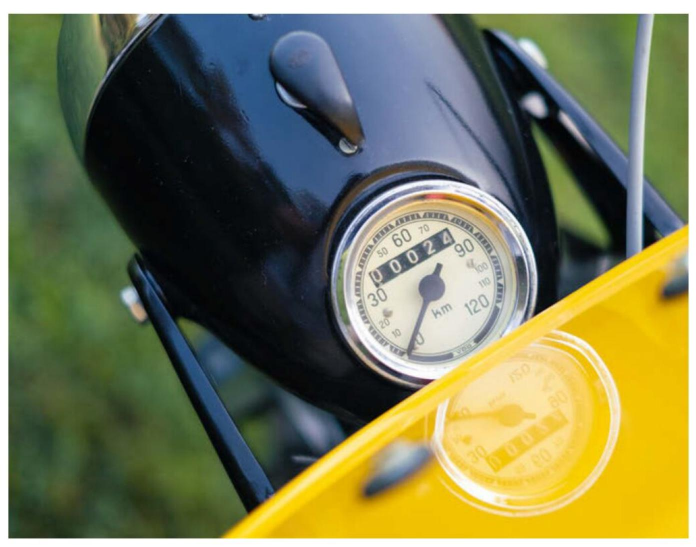
Inserito nel fanale il tachimetro/contachilometri della tedesca VDO scalato fino a 120 km/h. In vista anche la chiave di contatto necessaria per avviare la moto.
