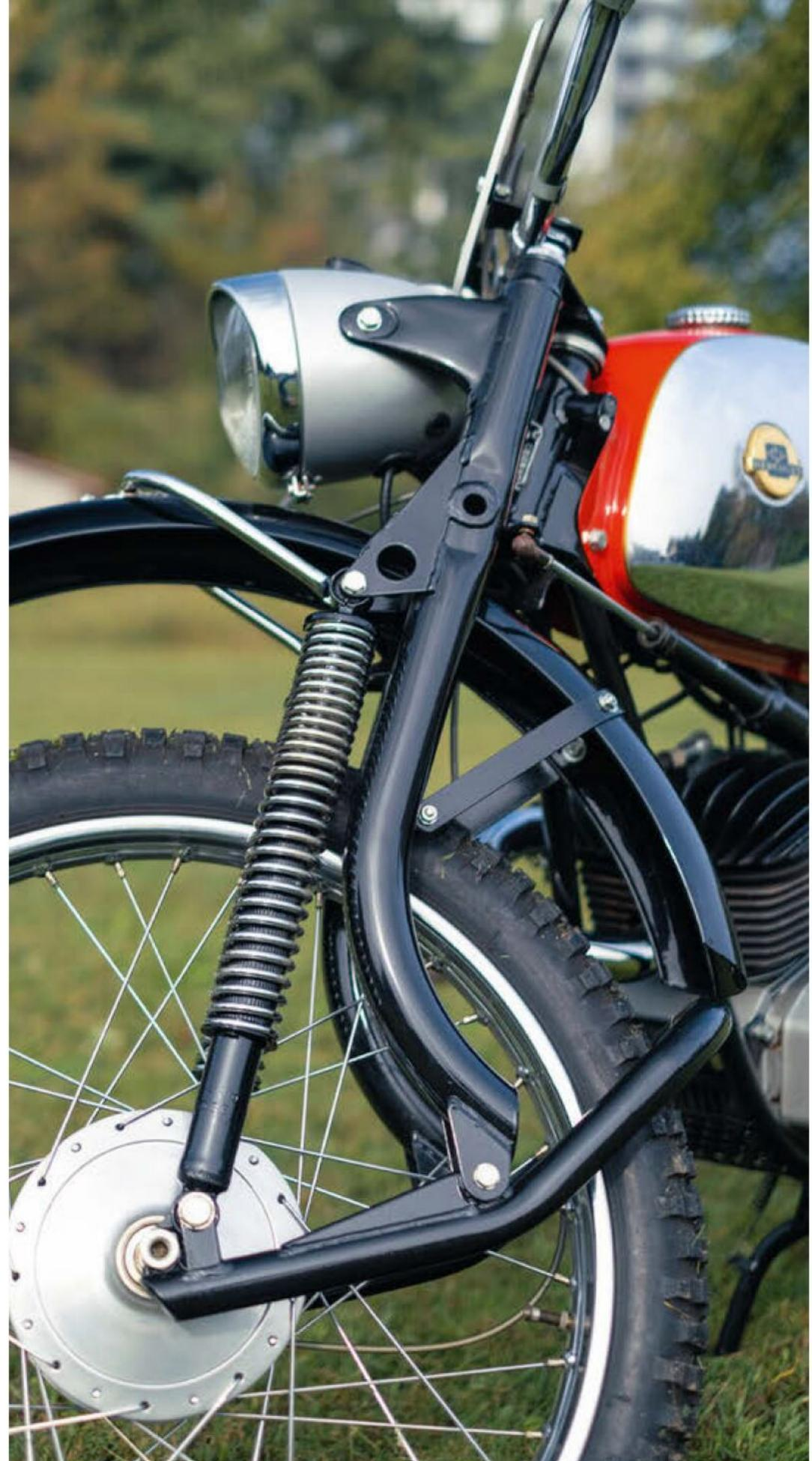
impiego di cromature, applicazione dell'antifurto sul cannotto di sterzo, dei lampeggiatori di direzione (che però in Italia non sono ammessi e vanno quindi tolti), degli ingrassatori sui cavi di comando con coperchietto per evitare l'ingresso del fango, batteria "trasparente" per verificare subito il livello, ecc.".
