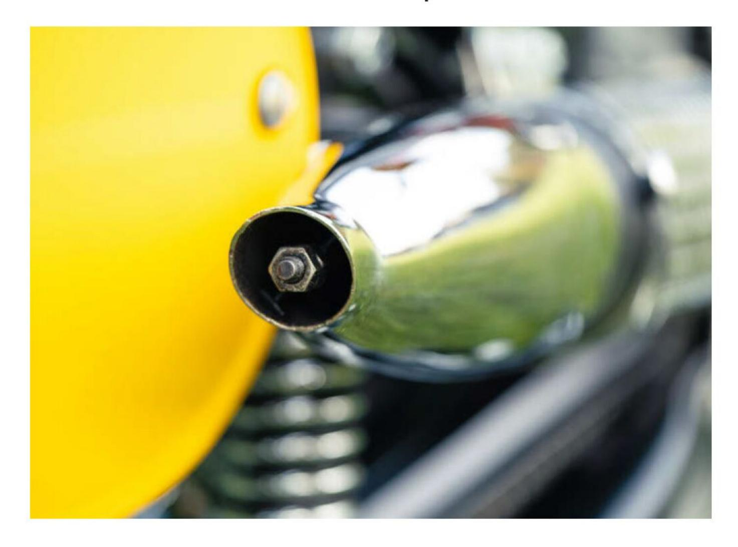
Il terminale della espansione Sachs è smontabile tramite il dado esagonale in vista; questo per eliminare le incrostazioni prodotte dagli oli minerali del tempo miscelati con la benzina per il 5%.
